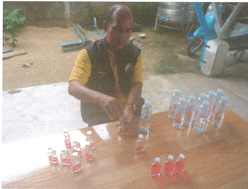
เอาตัวอย่างน้ำประปา ผสมกับน้ำยาทดสอบ อ.11
